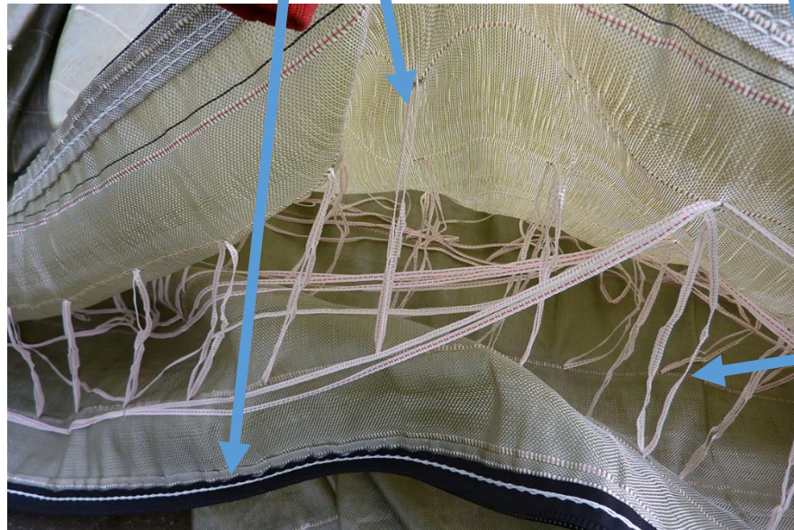
Dystansery zapewniające odpowiednią grubość betonowanej konstrukcji
